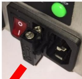
Abbildung 3 Wechseln der Sicherung
